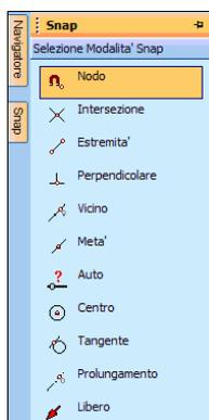
Se si sceglie l'opzione AUTO, muovendo il mouse sul file DXF importato saranno visualizzate, evidenziando in grassetto l'oggetto relativo, tutte le possibilità di osnap sullo stesso.
