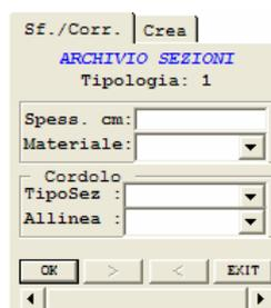
**Spess.** - Valore in centimetri dello spessore del setto.
