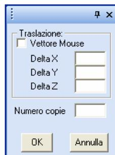
**Vettore Mouse** - Non si tratta di un dato numerico, poiché, quando il programma è in attesa di questo dato, è possibile solo tracciare con il mouse un segmento nello spazio (tra due nodi già esistenti), che rappresenta proprio il vettore spostamento. Se tale vettore viene tracciato risultano automaticamente assegnati i successivi tre dati, che rappresentano di quanto gli elementi copiati disteranno dalla struttura di partenza nelle tre direzioni parallele al sistema di riferimento globale.
