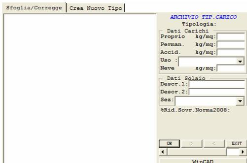
La tipologia di carico relativa a solai, balconi e scale dovrà essere definita introducendo tutti i dati necessari ad indicare tanto le azioni esterne (permanente e accidentale) quanto le caratteristiche costruttive degli stessi (peso proprio e sezione del travetto).
