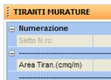
**Area Tiran.** – Area della sezione trasversale del tirante equivalente presente sulla parete in muratura. Si parla di tirante equivalente in quanto l'entità del dato richiesto è espressa in  $\text{cm}^2/\text{m}$ , bisognerà quindi dividere l'area reale della sezione di ciascun tirante per l'interasse espressa in metri. Nel caso in cui i placcaggi avessero un'interasse pari a 1 metro, l'area del tirante equivalente coinciderà con quella del tirante reale.
