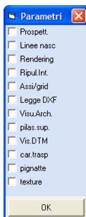
**Prospettiva** - Questa funzione va adoperata in maniera analoga all'apposita icona PIANTA/PROSPETTIVA ed ha lo scopo di passare da una visione in pianta della struttura ad una prospettiva e viceversa.
