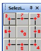
cioè, a seconda del valore associato al codice, si può far coincidere il filo fisso con uno dei vertici della sezione, con il punto medio di uno dei suoi lati, ecc.. Se si vuole posizionare il pilastro in modo che il filo fisso si trovi in una posizione differente da quelle predefinite proposte dal programma, basta dare il valore 0 a questo dato, ed intervenire sui disassamenti sotto descritti.
