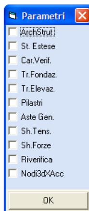
**ArchStrut.** - Questo parametro, valido solo per la stampa completa, consente di stampare, come riepilogo dei dati di input, soltanto quegli elementi dell'archivio delle sezioni generiche (acciaio e legno) che sono state utilizzati nel calcolo della struttura esaminata. Se lo disattiva, l'archivio delle sezioni generiche verrà stampato per intero.
