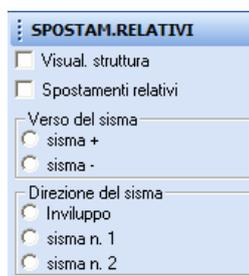
**Visual. struttura** - Attivando questa voce, verrà riportata a video, oltre alla rappresentazione degli spostamenti relativi, anche lo schema a fil di ferro della struttura in esame, così da meglio comprendere la disposizione degli stessi spostamenti su di essa.
