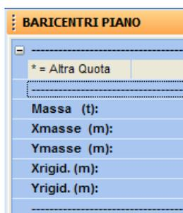
**Massa** - Massa sismica relativa all'impalcato di piano. Comprende la somma dei pesi propri degli elementi, dei sovraccarichi permanenti applicati e dell'aliquota sismica dei sovraccarichi accidentali. Per quanto riguarda setti e pilastri, il peso proprio viene ripartito in parti uguali sui piani superiore e
