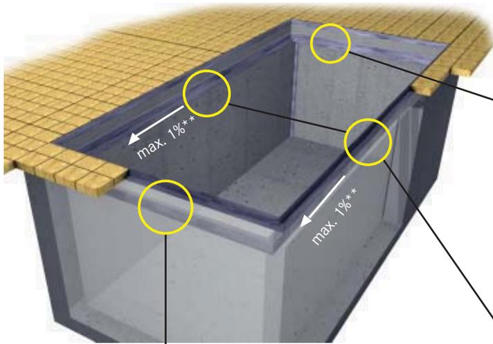
Illustrazione con rivestimento di piastrelle (senza impianto di parcheggio)
