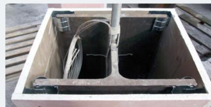
Struttura metallica realizzata mediante l'impiego di montanti e guide in acciaio Gyproc METALFRAME
