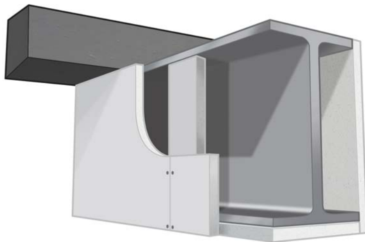
Protezione applicata ad elemento strutturale tipo trave
