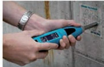
1. Posizionare lo strumento perpendicolarmente alla superficie di prova.
