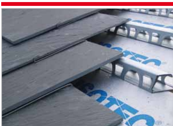
Esempio di fissaggio tegole in ardesia comunemente dette "bastarde" (cm 57 x 40 x 1) su ISOTEC passo 19 tramite gli appositi ganci forniti a corredo dai fornitori delle tegole.
