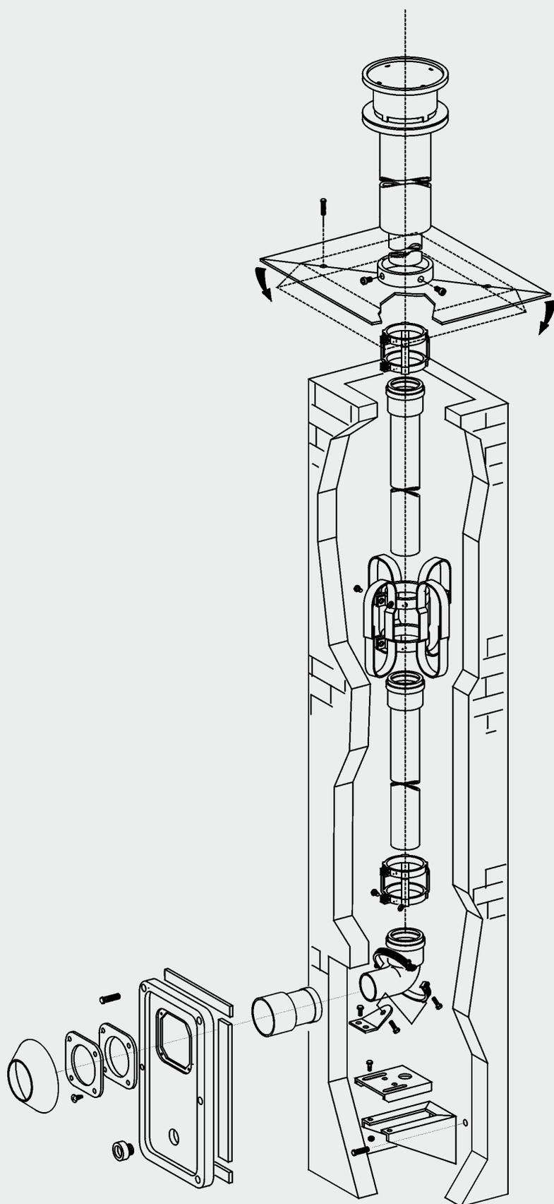
Esempio di kit intubamento rigido Ø 60 mm
