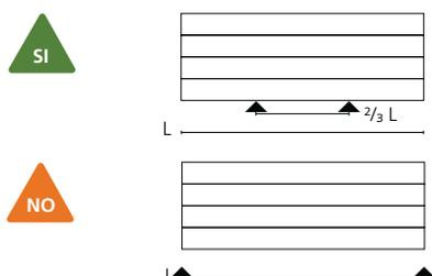
I singoli pannelli possono essere steccati indifferentemente in orizzontale o in verticale, a condizione che vengano opportunamente fissati agli appoggi, specialmente se sussistono probabilità di folate di vento.
