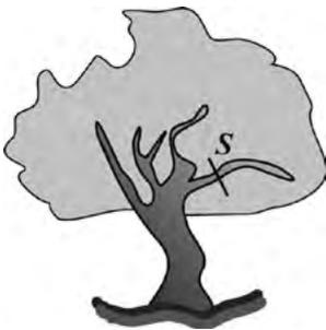
Esistono invece delle strutture, che presentano dei campi chiusi, in cui un taglio non è sufficiente per suddividerle in due corpi indipendenti: le strutture che hanno tale proprietà prendono il nome di *strutture molteplicemente connesse*. Il numero di campi chiusi presenti in un sistema monodimensionale prende il nome di *grado di connessione* e si indica con *gc*.
