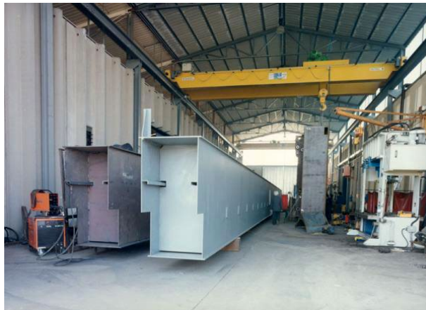
Figura 2.20. Vie di corsa per carroponte
