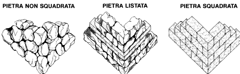
Figura 3.2. Tipologia delle murature in pietra naturale (AA.VV., Il progetto , AMPAE)
