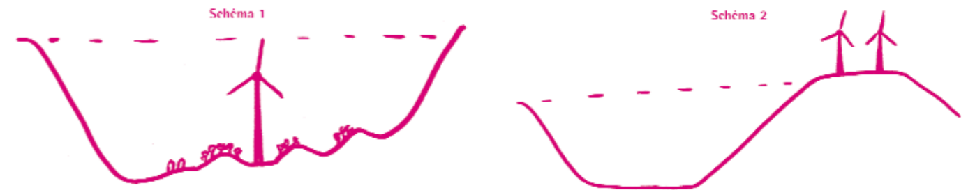
Figg. 45-46. Eolico e architettura dei luoghi: il primo schema si riferisce alla depressione valliva di Fagne e Famenne in Wallonia. Lo studio fa notare come, al fine di proteggere i paesaggi caratterizzati da grandi avvallamenti la cui ampiezza altimetrica in cresta è pari all'altezza delle moderne macchine eoliche, è opportuno evitare l'installazione in questi luoghi di macchine il cui sviluppo verticale farebbe perdere la percezione della profondità che risulta essere la dimensione fondamentale per il riconoscimento di questo tipo di paesaggio. Vanno, allo stesso tempo, preservate le zone sommitali (schema 2) che costituiscono spesso l'orizzonte visivo dell'osservatore.
