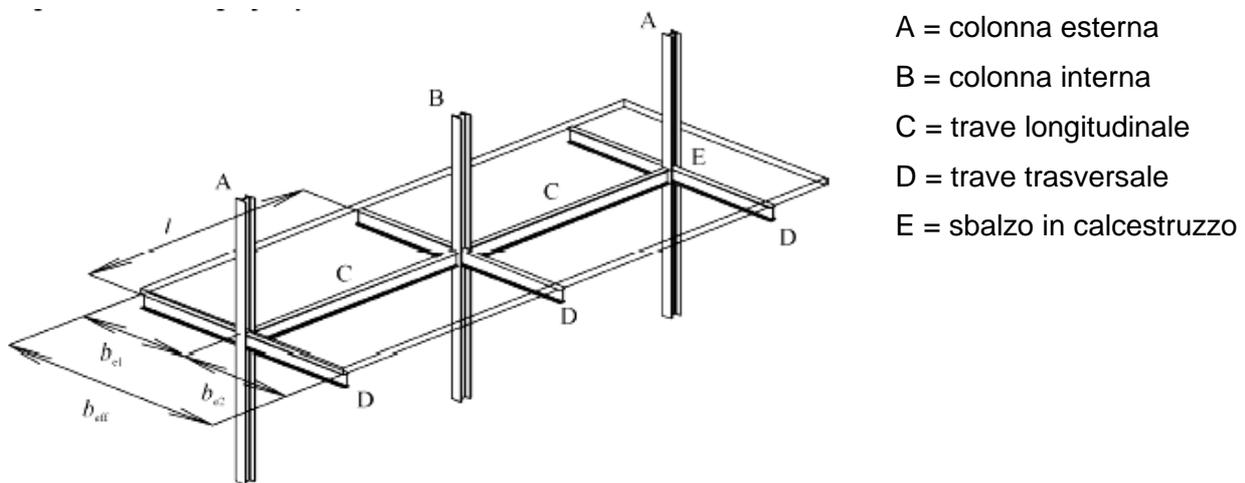
Figura 7.6.2 - Definizione degli elementi in una struttura intelaiata
