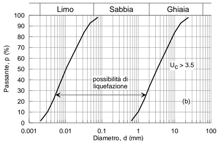
**Figura 7.11.1** – Fusi granulometrici di terreni suscettibili di liquefazione.
