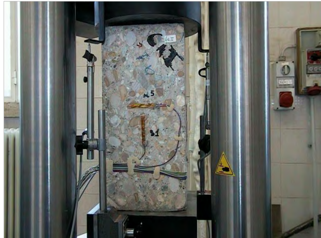
Figura 2.19 Campione di prova sottoposto a compressione
