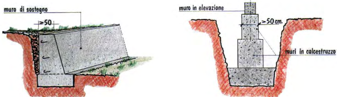
Fig. 5.38 – impiego del calcestruzzo per muri di sostegno e murature di fondazione
