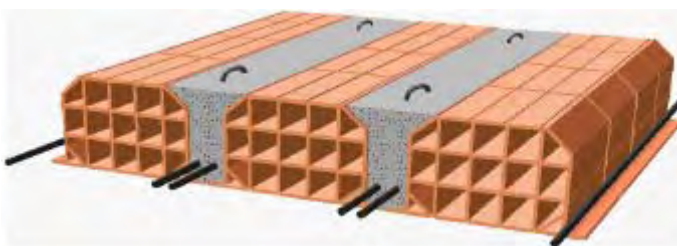
Figura 10.13 – Solai a pannelli prefabbricati
