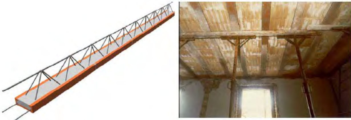
Figura 10.9 – Solai in c.a. con travetti intralacciati
