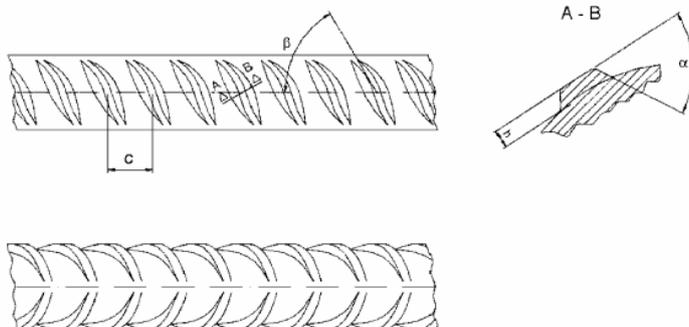
nelle barre di acciaio dentellate, o anche “improntate”, le nervature sono ottenute producendo delle impronte sulla sezione circolare piena, sicchè la sezione effettiva che si ottiene ha una forma approssimativamente triangolare o quadrata, a seconda che le facce nervate siano rispettivamente tre o quattro.
