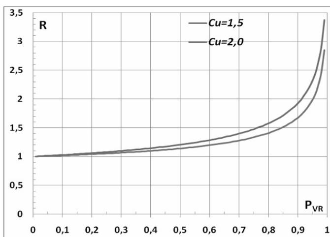
Figura C3.2.2 – Variazione di  $R$  con  $C_U$  e  $P_{V_R}$ .
