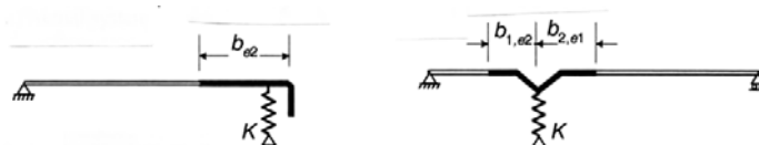
Figura C4.2.31 – Schematizzazione degli irrigidimenti
