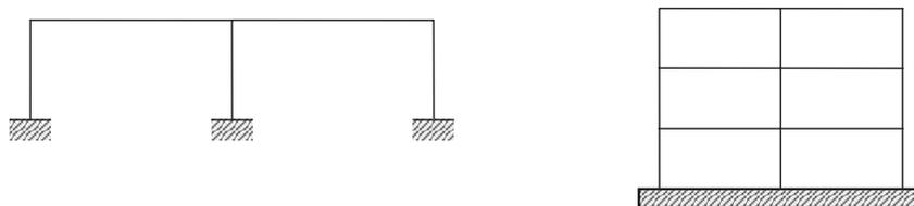
Fig. C7.4.1.- Strutture a telaio con collegamenti monolitici
