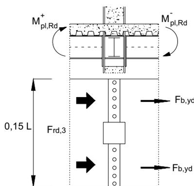
Fig. C7.6.4. Meccanismo 3 – Connettori a taglio sulle travi secondarie
