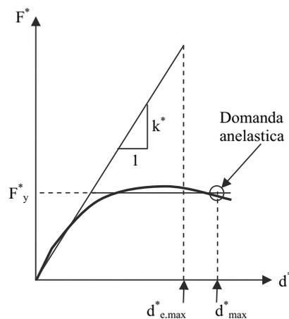
Figura C7.3.2a – Spostamento di riferimento per  $T > T_c$
