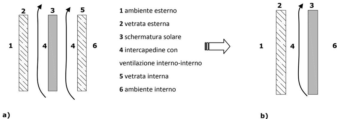
Figura 9 – Schematizzazione di una schermatura solare integrata con intercapedine ventilata interno su interno e del suo sistema equivalente ai fini del calcolo semplificato del fabbisogno estivo
