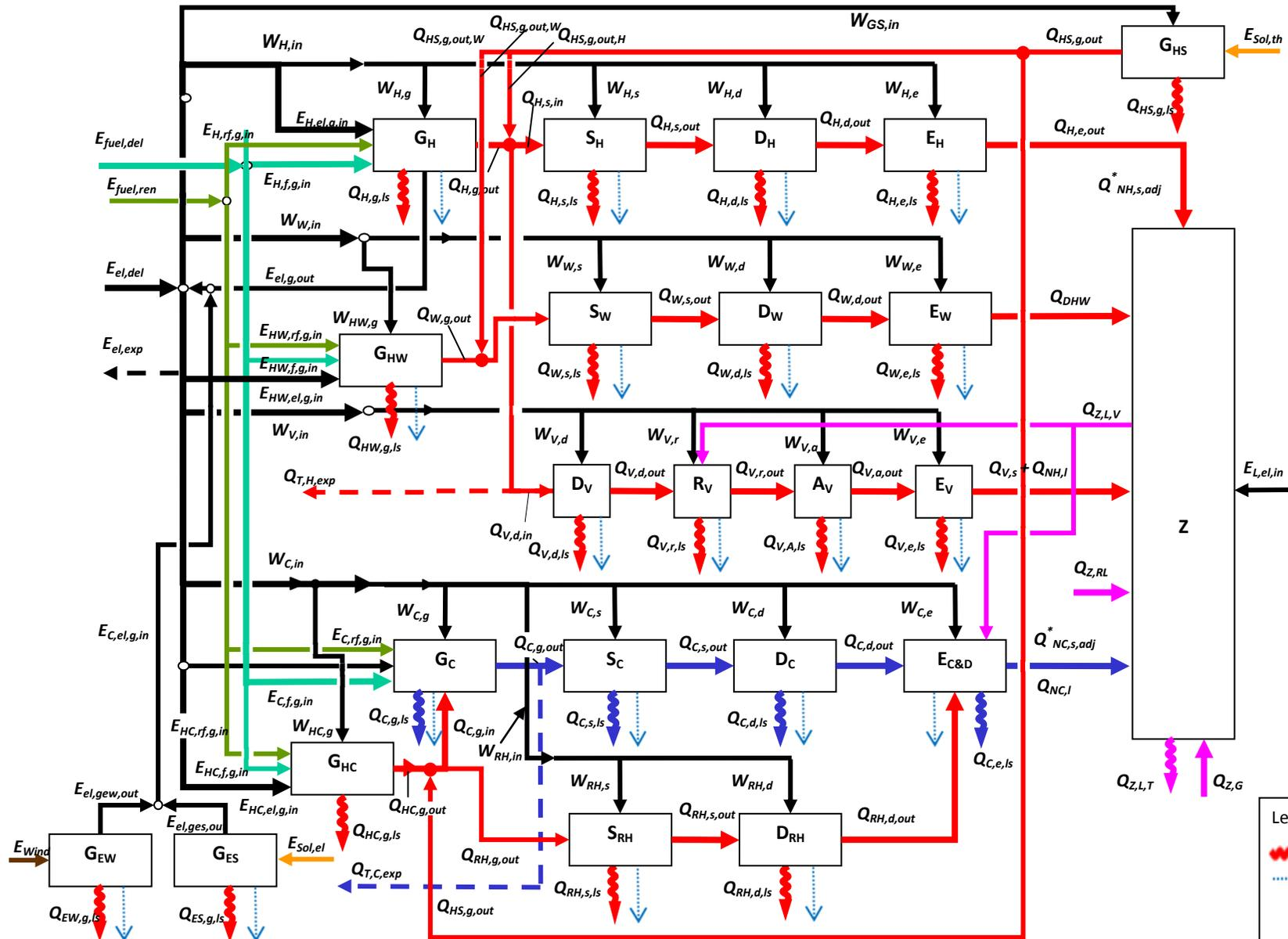
Figura 12 – Schematizzazione dell'impianto termico con generazione termica separata
