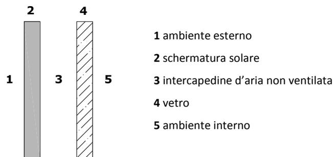
Figura 5 – Schematizzazione di una schermatura solare esterna
