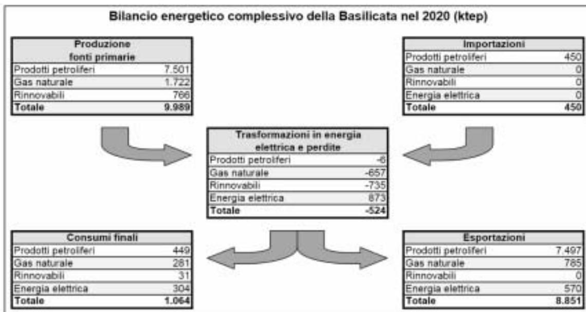
**Fig. 3<sup>o</sup> - L:** Schema di sintesi del bilancio energetico complessivo della Basilicata nel 2020<sup>42</sup> (fonte: Regione Basilicata).
