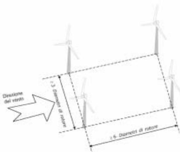
Fig. A - B: Distanze minime tra aerogeneratori.
