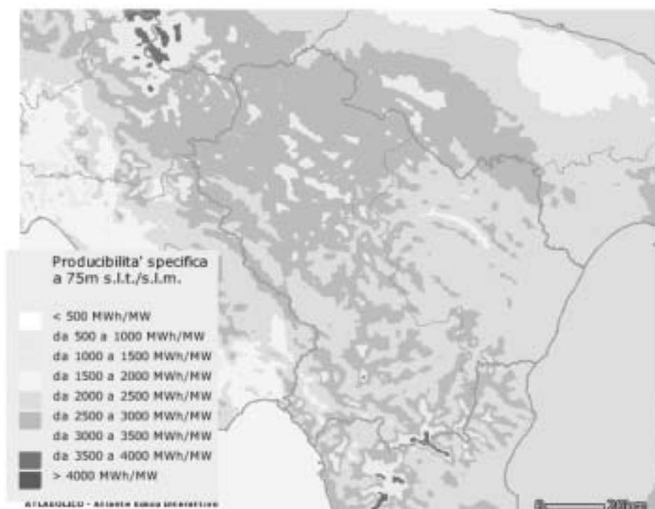
**Fig. 3' - D:** Carta della producibilità specifica (in MWh/MW) a 75 m di altezza dal suolo
