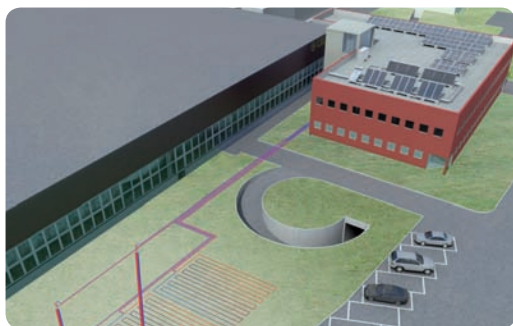
Disposizione sonde orizzontali e verticali rispetto all'edificio Centro Ricerche
