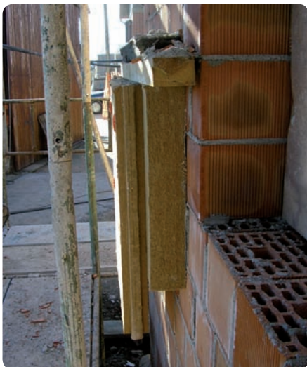
Prova meccanica su cappotto. Sono stati caricati 120 kg e non si è registrato alcun cedimento meccanico del cappotto.
