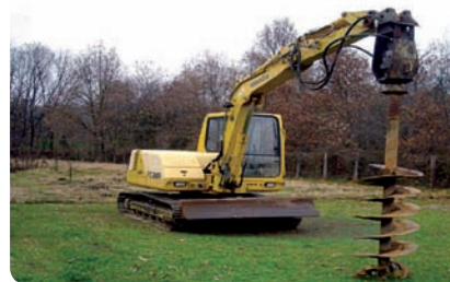
Escavatore attrezzato per la posa dei basket geotermici
