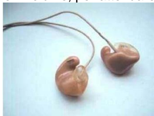
Figura 5. Monitor intrauricolari personalizzati (Fonte: Linee guida europee [1]).
