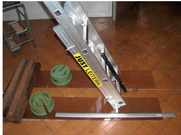
Figura 4.2.1-3 Scala con tronchetto, ruotino in sommità, superficie di prova in HPL e tiro alla base
