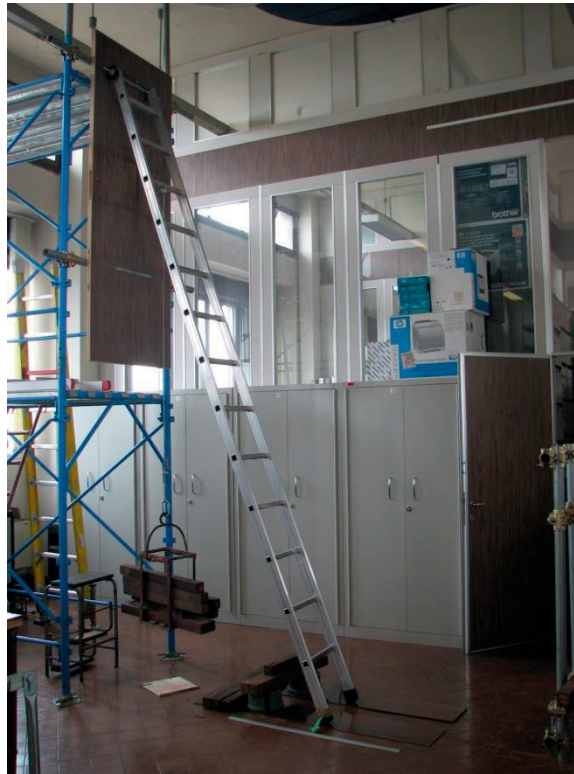
Figura 4.2.1-5 Prova su scala senza tiro alla base e con aumento progressivo del carico appeso
