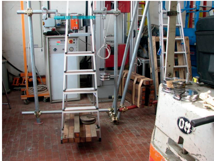
Figura 4.3 - 1 Prova di instabilità laterale su scala doppia
