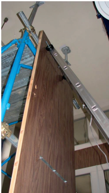
Figura 4.2.1-4 Particolare del ruotino in sommità e del sistema di misurazione della distanza di scivolamento
