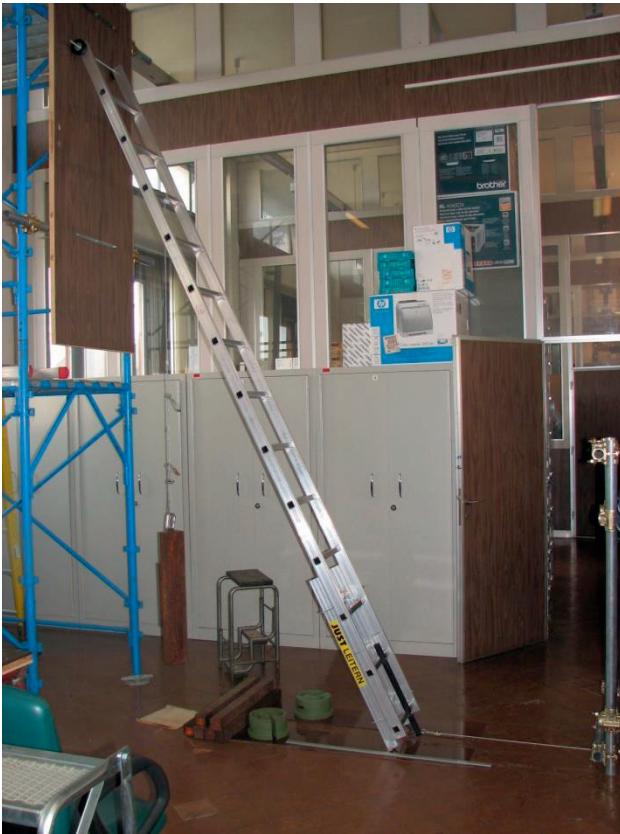
Figura 4.2.1-3 Scala con tronchetto, ruotino in sommità, superficie di prova in HPL e tiro alla base
