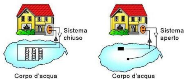
Figura 28. Schemi semplificati di sistemi con pompe di calore[Fanelli e Dickson, 2004].
