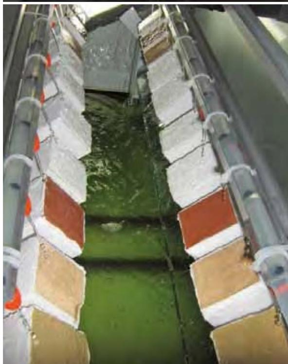
1. Acquario in vetro utilizzato per la prova di crescita accelerata in laboratorio.
