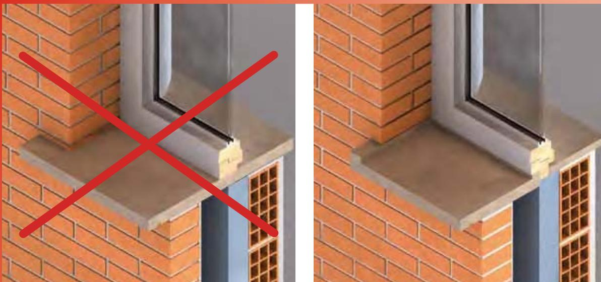
Figura 5 – Risoluzione del ponte termico nel punto di connessione fra serramento – davanzale – chiusura opaca mediante distacco del davanzale esterno in corrispondenza dello strato isolante.
