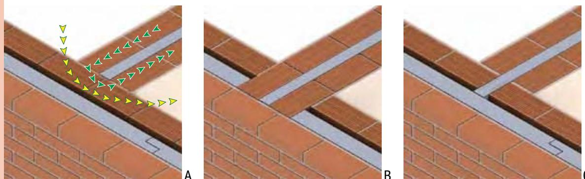
Figura 7 – Alcune configurazioni del collegamento tra parete divisoria interna e parete di facciata a doppio strato in elementi di laterizio.
