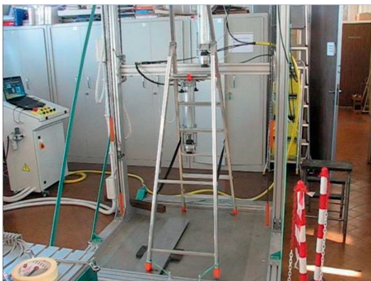
Figura 5.2 – 3 - Attrezzatura di prova per test di durabilità
