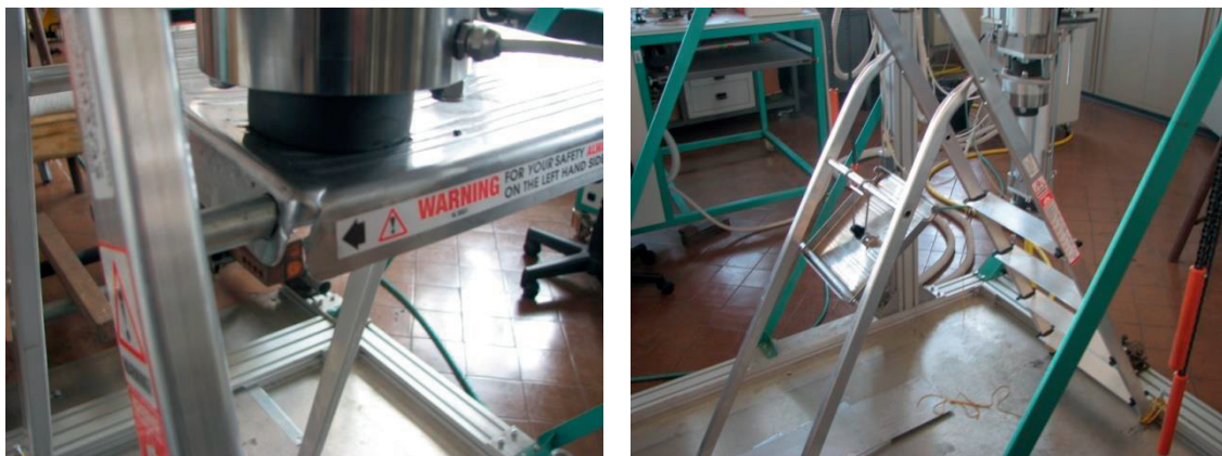
Figura 5.3.1- 6 Scala modello U2 classe 3 BS 2037
