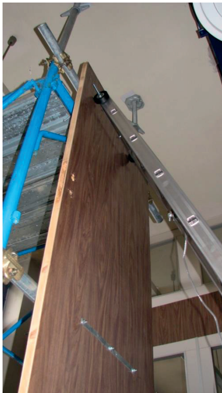
Figura 4.2.1-4 Particolare del ruotino in sommità e del sistema di misurazione della distanza di scivolamento
