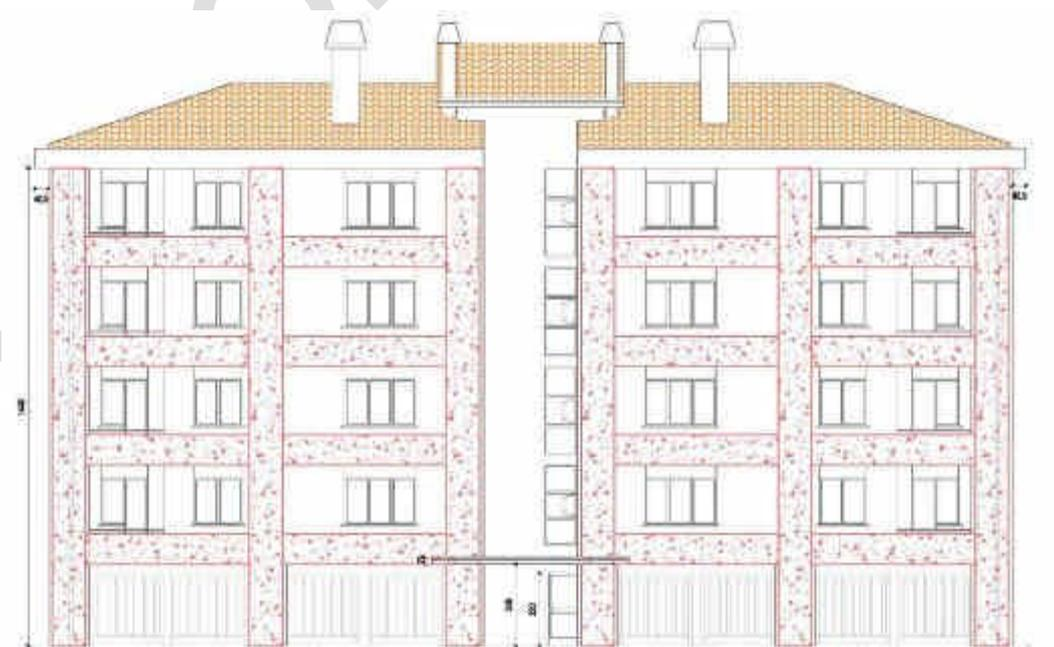
Figura 10 Progetto di miglioramento sismico: posizionamento nuovi setti e travi
