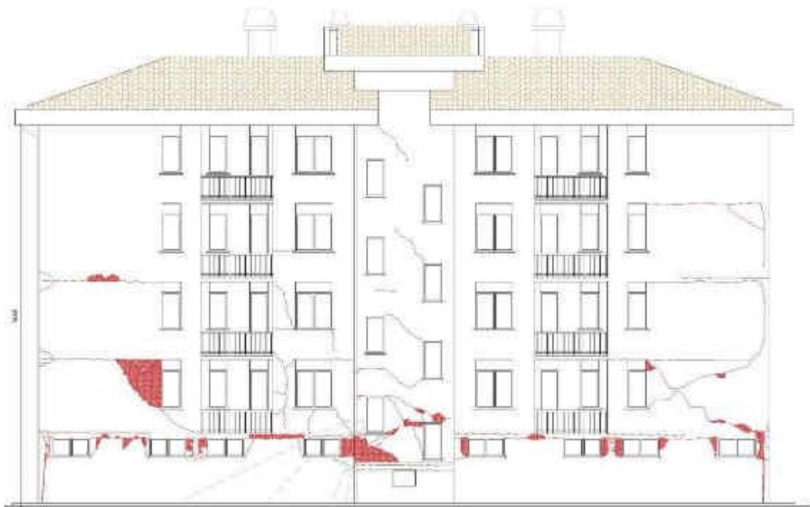
*Figura 4 Rilievo di alcune lesioni esterne dell'edificio situato in Via Francia 28*
