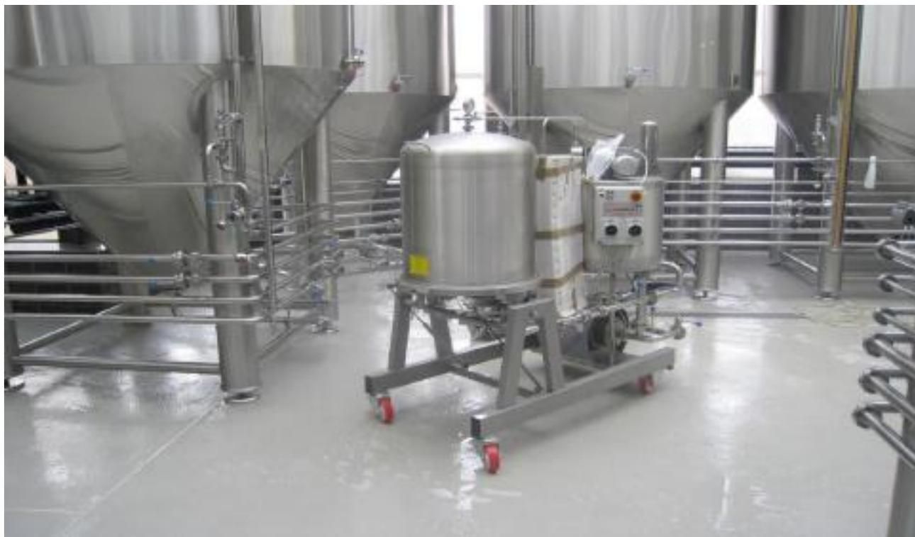
Sono definiti, molto semplicemente, con i termini *epossi-cemento* o *poliuretano-cemento*. I prodotti così ottenuti presentano caratteristiche chimico-fisiche particolari; ciò è vero soprattutto per i poliuretano-cemento, la cui resistenza chimica e agli shock termici fa sì che siano ampiamente utilizzati nelle aziende alimentari.
