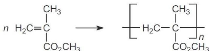
Polimerizzano per azione di un catalizzatore, in genere perossido di benzoile al 50% (formula abbreviata PBO). La velocità di reazione può essere modificata (rallentata o accelerata) variando la
