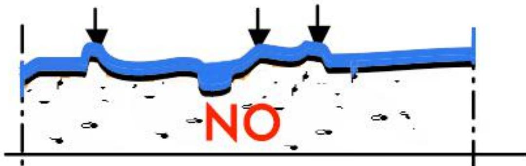
Il rivestimento a film sottile si distribuisce sulla superficie, formando, in corrispondenza delle punte, uno spessore minimo o nullo in relazione all'altezza dell'asperità e alla quantità di materiale.
