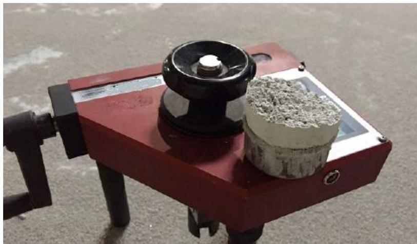
Si deve verificare che dopo lo strappo del dolly la rottura sia sempre di tipo **coesivo** (*distacco del rivestimento con parte del sottofondo*) e che tale presenza di parte della superficie di posa, aderente alla superficie del dolly, sia maggiore del 50% della superficie del dolly:  $a \geq 0,5 A$ .
