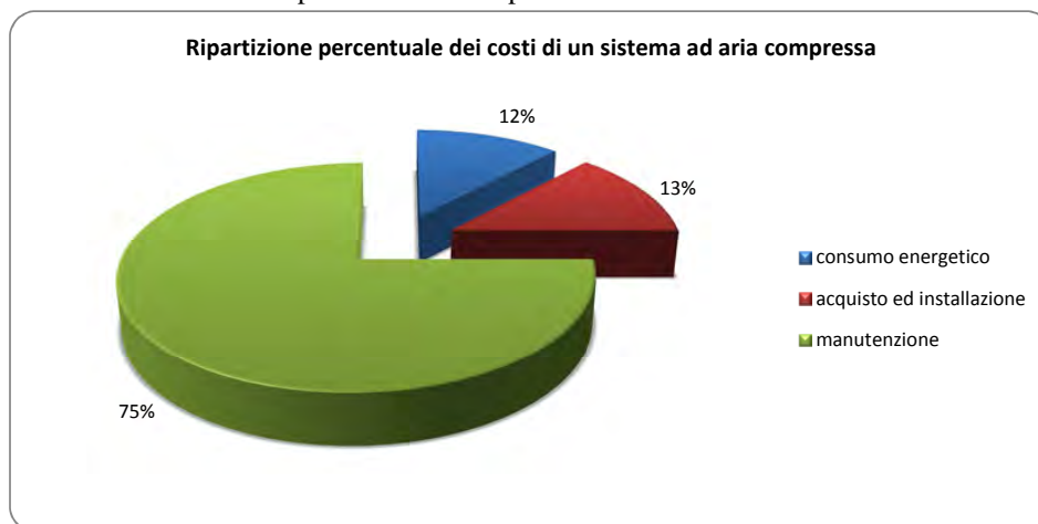
Figura C-10 Ripartizione percentuale dei costi di un sistema ad aria compressa su un orizzonte temporale di 10 anni
