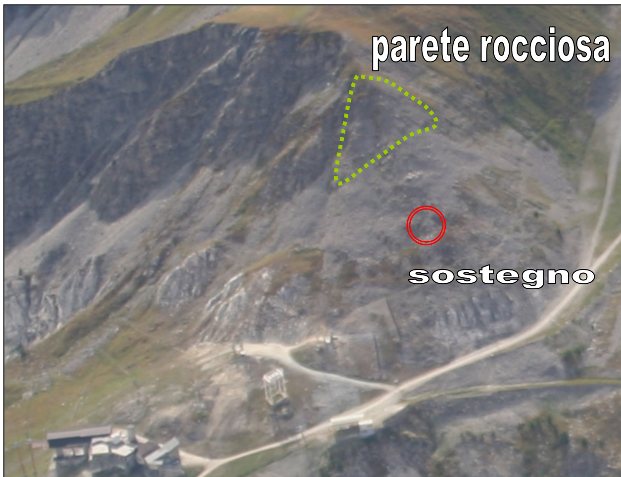
Figura 16: in evidenza la piccola parete a monte dell'ammasso detritico su cui è previsto il sostegno in progetto
