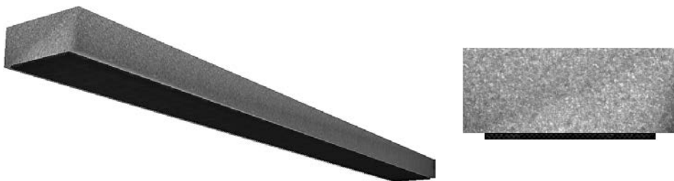
Figura 9.1. Rinforzo a flessione trave in c.a. mediante tessuto unidirezionale in fibra di carbonio
