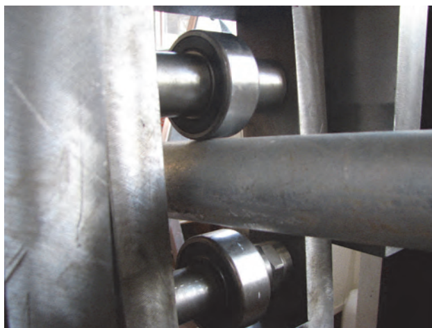
Figura 3-3 Accessorio per il trasferimento dello spostamento della traversa della macchina di prova al traverso del dispositivo di collegamento sottoposto a prova
