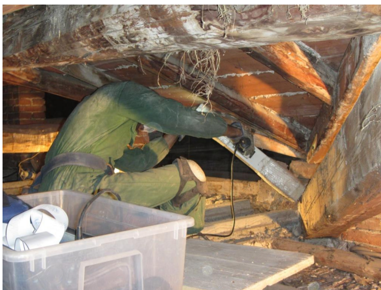
Foto 2 – Indagine strumentale mediante trapano strumentato.
