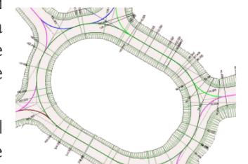
I raccordi previsti sono del tipo: circolare, a clotoide simmetrica ed asimmetrica, parabolico, tornante. Un raccordo particolare è costituito dalla curva composta denominata **raccordo di continuità**, già sperimentata con successo in diverse progettazioni ferroviarie per linee ad alta velocità.
