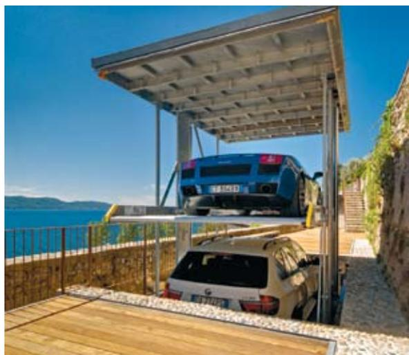
*L'installazione di questi sistemi, quattro impianti da due posti auto ciascuno, ha permesso di creare 8 parcheggi indipendenti. Possono essere parcheggiate auto fino ad un'altezza di 2 metri ed un peso di 2600 kg.*
