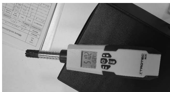
Figura 3.1. Rilevazione dei parametri termoigrometrici dell'aria
