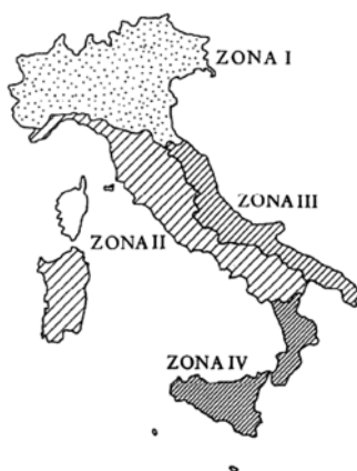
Figura 6.1. Zone della temperatura dell'aria esterna (Fig. 3.5.1 delle NTC 2018)
