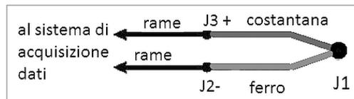
**Figura 3.2.** Collegamento di una termocoppia
