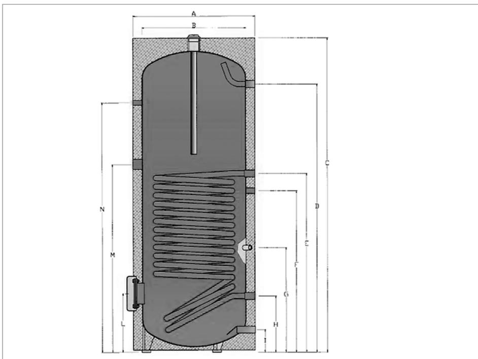
**Figura 5.1.** Bollitore per l'accumulo di acqua sanitaria: **A.** Diametro esterno del bollitore; **B.** Diametro caldaia; **C.** Altezza bollitore; **D.** Uscita acqua calda; **E.** Entrata serpentino; **G.** Attacco sonda; **H.** Uscita serpentino; **I.** Entrata acqua calda; **L.** Flangia ispezione diametro 180 mm; **M.** Attacco resistenza elettrica; **N.** Attacco termometro
