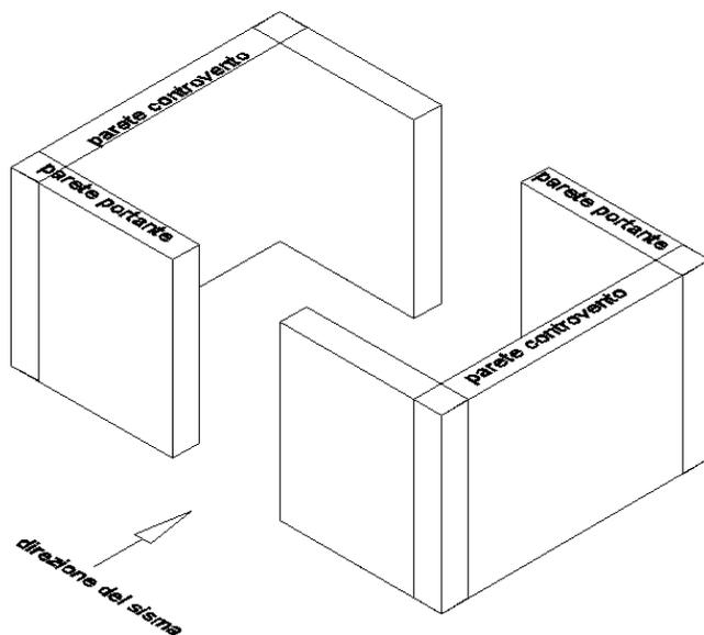
I muri portanti si dicono «pareti di controvento» quando sono chiamati a resistere ad azioni sismiche complanari. Essi svolgono funzione portante, quando sono sollecitati prevalentemente da azioni verticali. Ai fini di un adeguato comportamento statico e dinamico dell'edificio, tutti le pareti devono assolvere, per quanto possibile, sia la funzione portante sia la funzione di controventamento.
