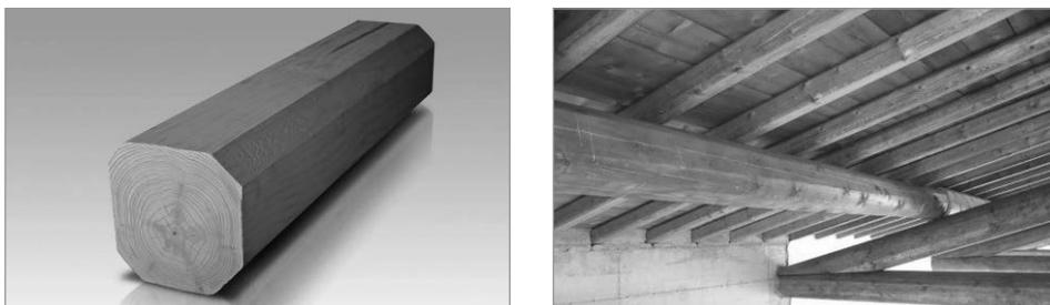
Figura 2.1. Esempio di legno massiccio
