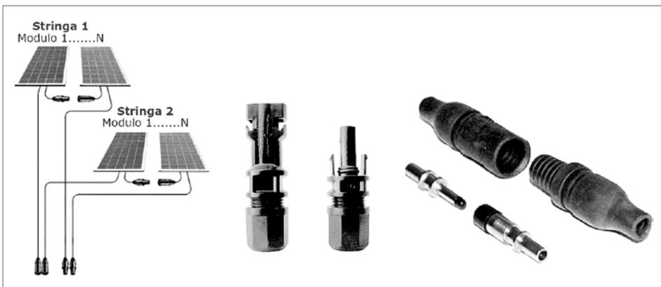
**Figura 6.1.** Interconnessione dei moduli a costituire stringhe da attestare successivamente ad un quadro o inverter
