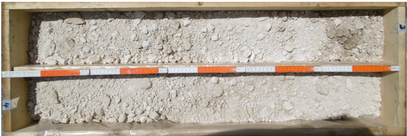
Foto 8: Deutlich feinkörniger Abschnitt mit stark sandigen Kiesen in Bohrung B2 im Tiefenabschnitt 4 – 6 m.
