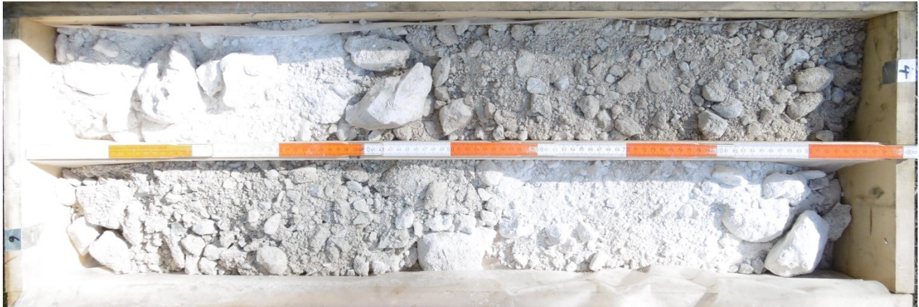
Foto 7: Sandige, schwach steinige Kiese mit zerbohrten Klasten (?Stein und Blockkomponenten) in Bohrung B1, Bohrabschnitt 4 – 6 m.
