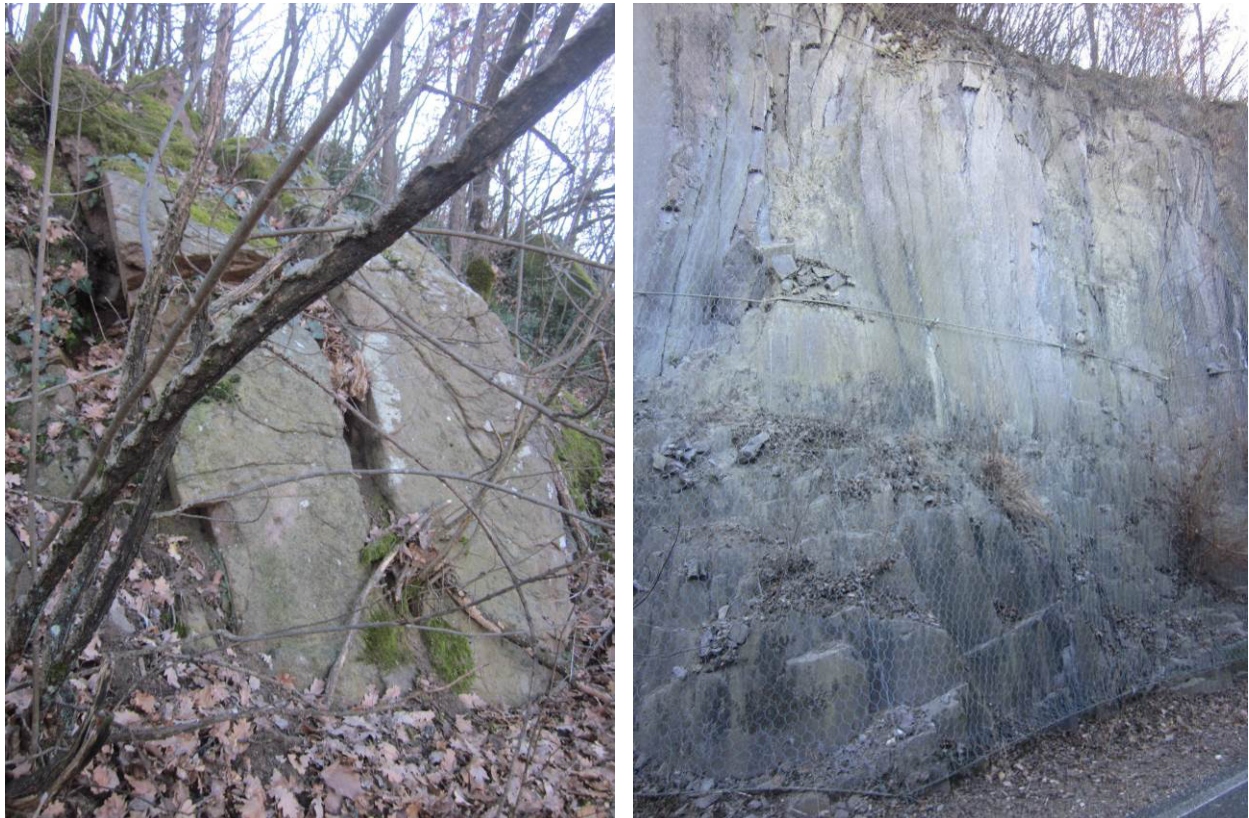
Abbildung 10: Abbildung der beiden unterschiedlichen Lithologien; wie man sehen kann, sind beide Einheiten von senkrechten Spalten gekennzeichnet. Genau so sichtbar ist der Unterschied im Öffnungsgrad der Brüche, was zu einer unterschiedlichen Durchlässigkeit der beiden Einheiten führt.
