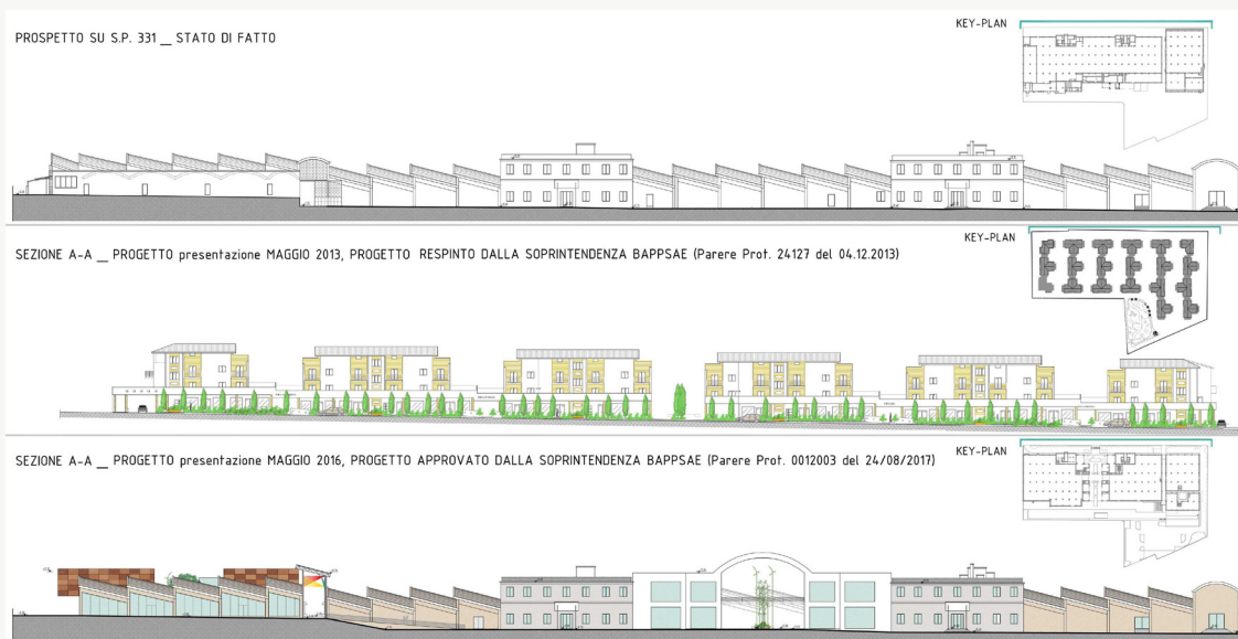
Figura 1 – Prospetti a confronto: stato di fatto (in alto), progetto del 2013 respinto dalla Soprintendenza (al centro), progetto del 2016 approvato dalla Soprintendenza (in basso)
