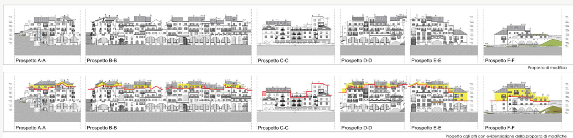
Figura 1 – Prospetti dell'intervento: proposta di modifica (sopra), e progetto agli atti con evidenziazione della proposta di modifica (sotto). In giallo le modifiche in riduzione, la linea rossa indica l'altezza della linea di gronda della possibile modifica
