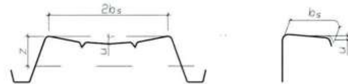
Figura C4.2.25 –Incurvamento delle piattabande
