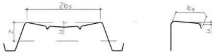
Figura C4.2.25 –Incurvamento delle piattabande
