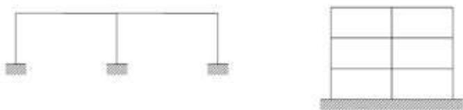
**Figura C7.4.4** - Strutture a telaio con collegamenti monolitici
