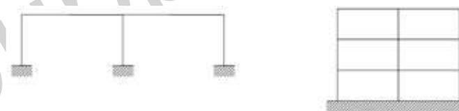
**Figura C7.4.4** - Strutture a telaio con collegamenti monolitici
