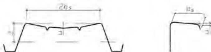
Figura C4.2.25 –Incurvamento delle piattabande
