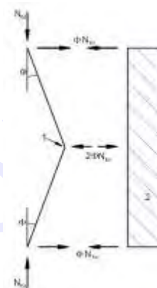
Figura C4.2.6 - Forze equivalenti nelle giunzioni di elementi o piattabande compresse
