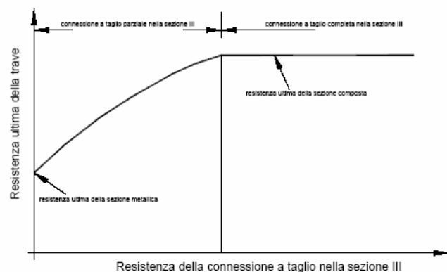
Figura C4.3.6 – Legame tra resistenza della trave e resistenza della connessione
