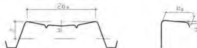
Figura C4.2.25 –Incurvamento delle piattabande
