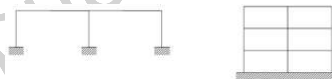
Figura C7.4.4 - Strutture a telaio con collegamenti monolitici
