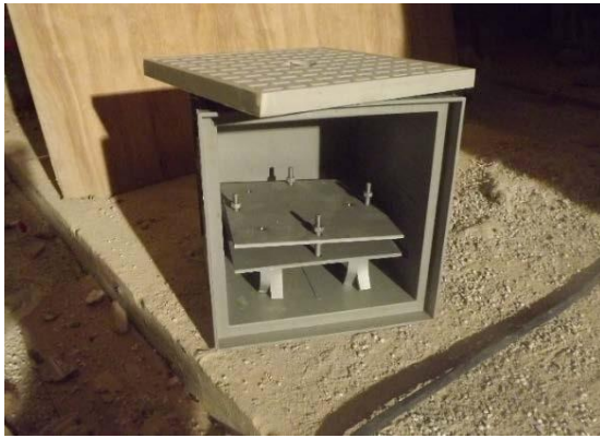
FOTO 5 - PIASTRA E BOX CHE ACCOGLIE IL SENSORE ACCELEROMETRICO
