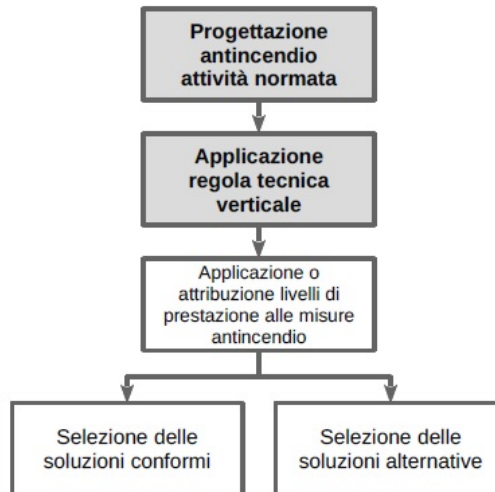
Illustrazione G.2-3: Progettazione antincendio delle attività normate
